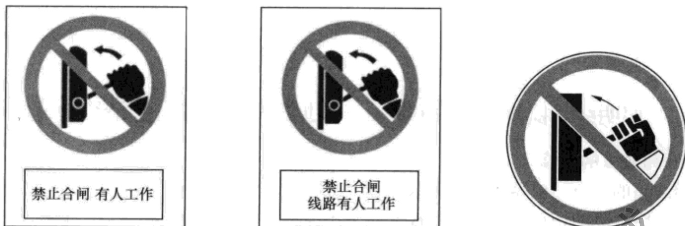
图 2-19 停电检修警告牌
