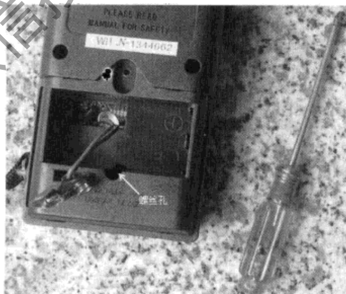
图 6-13 取出电池后再拆卸
