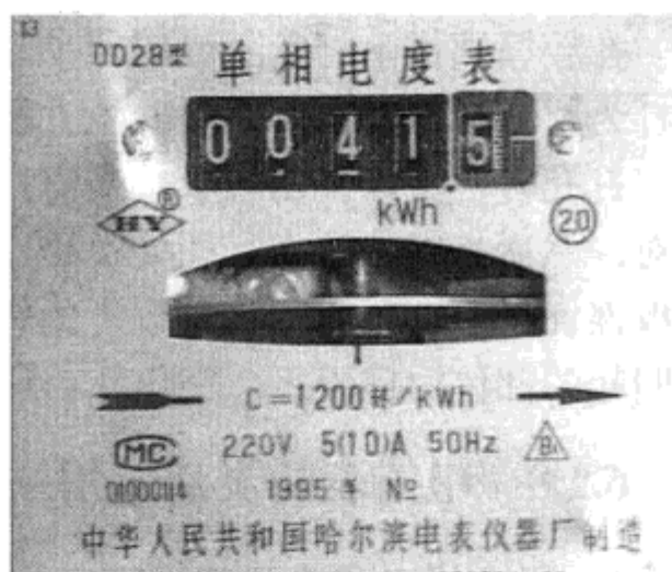
图 6-17 电能表额定参数的标示
