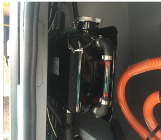
膨胀水箱，根据水箱边上指示刻度线加适量冷却液。
