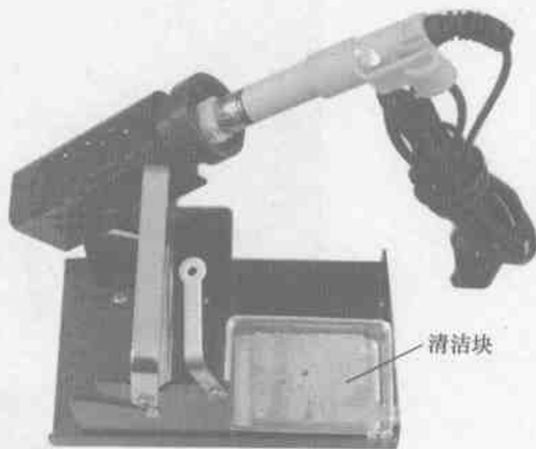
图 7-37 将电烙铁放在烙铁架上
