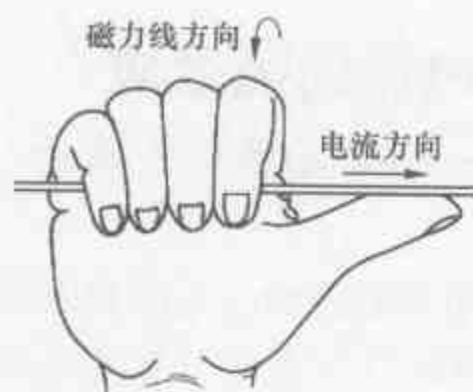
图 2-3 用安培定则一判定通电直导线的磁力线方向
