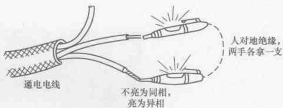
图 7-6 用试电笔区分交流电同相或异相的方法
