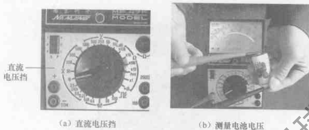
图 7-46 测量直流电压
