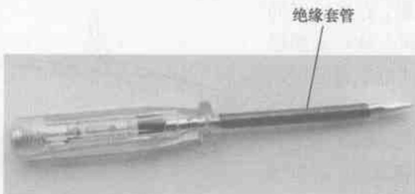
图 7-5 在刀杆上加装绝缘套管
