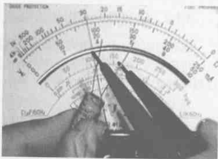
图 3-9 用万用表测量电容器
