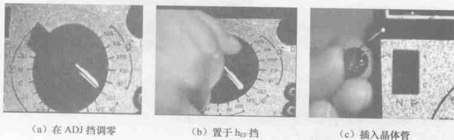
图 7-48 测量晶体管的 \beta 值
