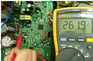
主板断电后的高压残电
