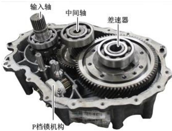
图 4-9 减速器内部结构
