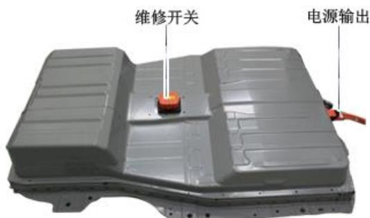
图 1-2 动力电池总成
