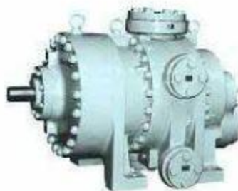
图 1-12 MAYCOM 公司开发的 CO 2 螺杆压缩机
