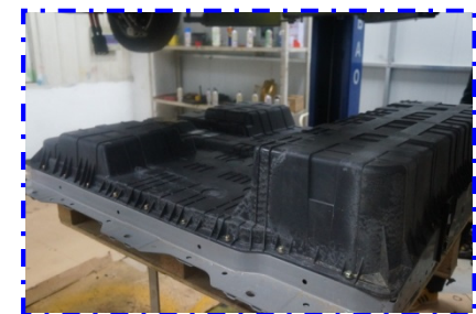
碰撞后完好的电池
