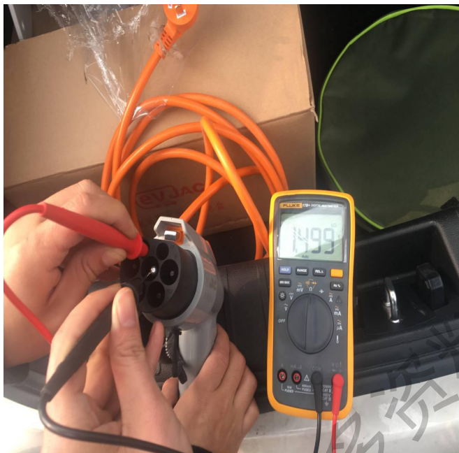
家用充电线缆测量CC信号 与PE阻值为1.5KΩ
