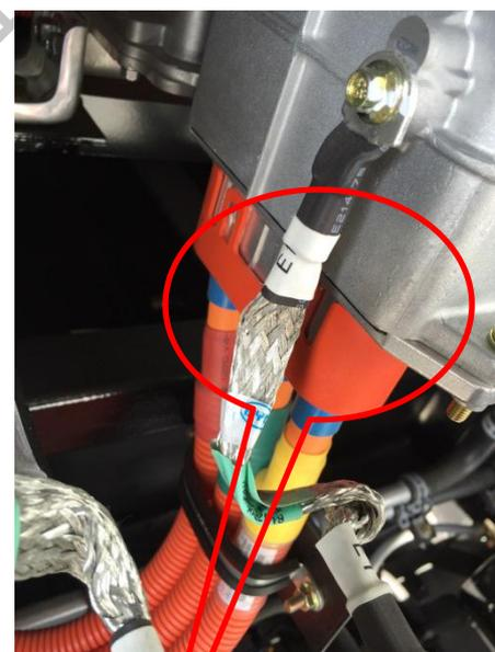
电机旋变接插件定义
