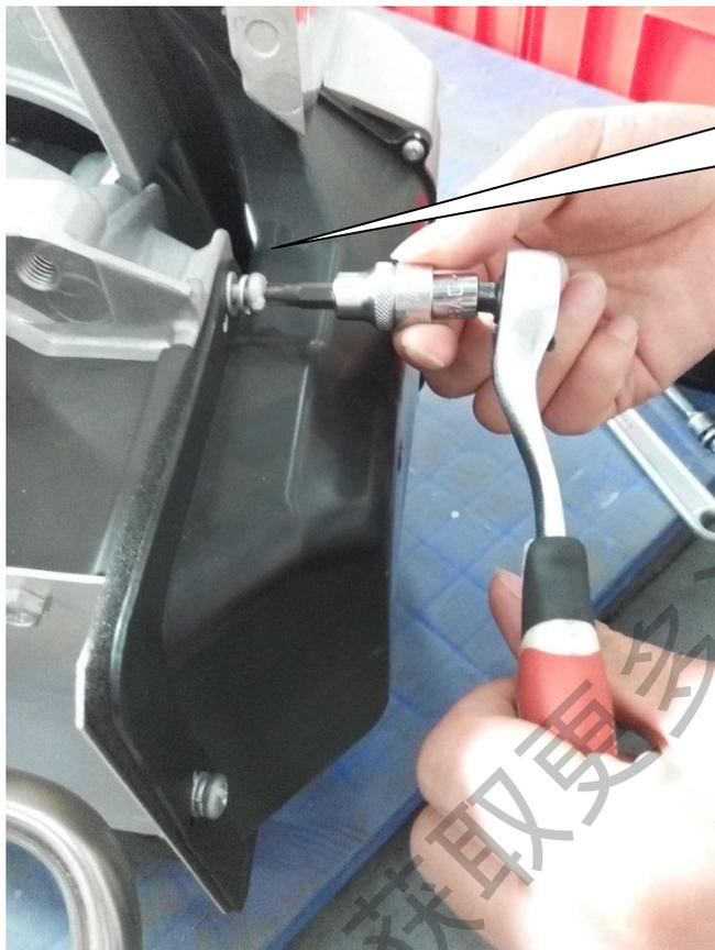
用十字套筒棘轮扳手拆下3个M6十字槽盘头螺钉,
