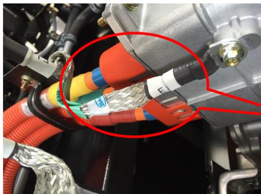
检查此处是否有脱皮、破损，同时拆开此处用万用表检查电机是否对地短路
