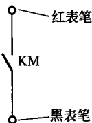
图 2-4-5 使用前接触器 KM 辅助触点中的常开触点的检测
