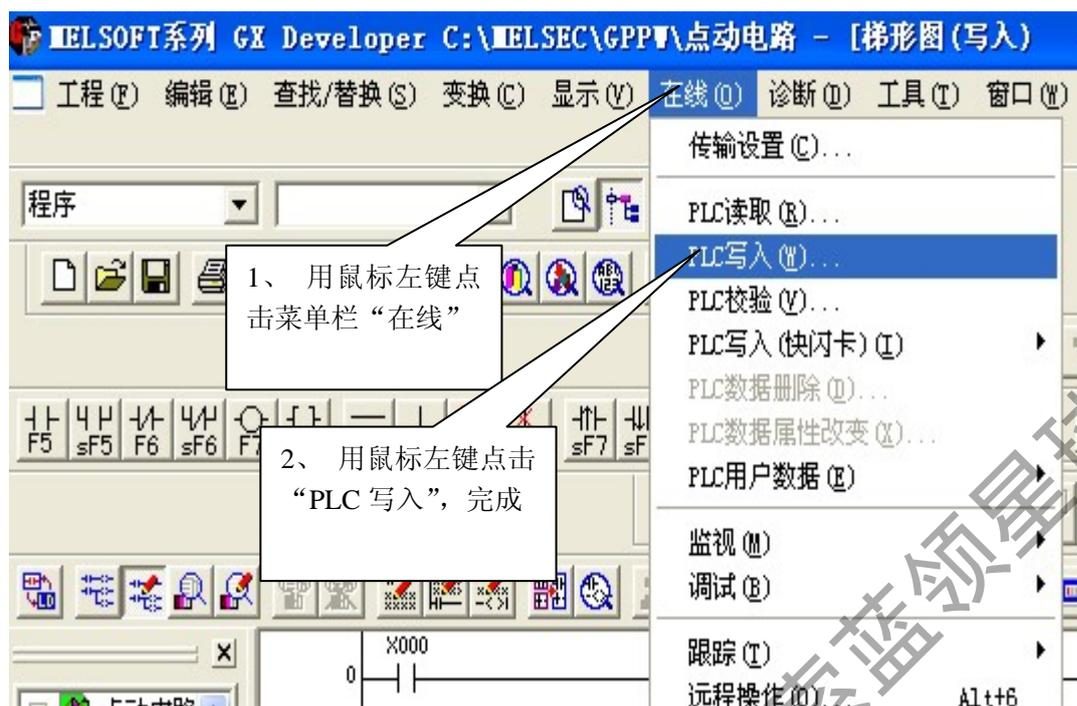
图 4-26 将计算机已编译程序写入 PLC
