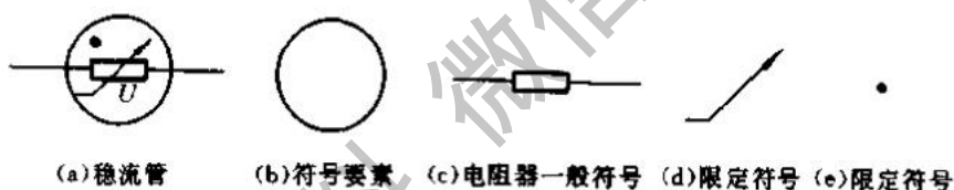
图 1-6 稳流管图形符号的组成
