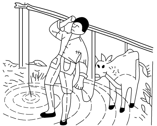
图 1-58 跨步电压触电
