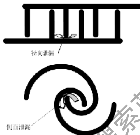
图 3-36 膨胀机的径向泄漏和侧面泄漏
