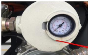
打气泵压力表，一般汽车开启后，打气泵工作至正8MPa排气，全车气动刹车、门泵靠此供气。全车重要部件。
