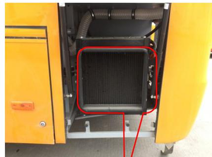
电机控制器散热风扇。
