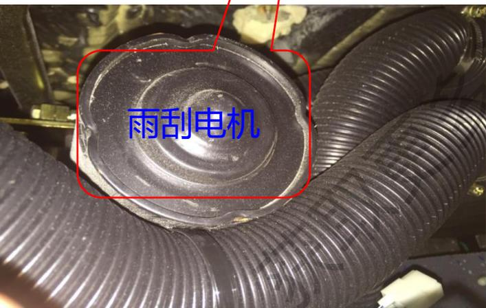
雨刮水壶中应存有适量水。否则雨刮干刮洗前挡玻璃时，会由于阻力过大造成雨刮总成损坏。
