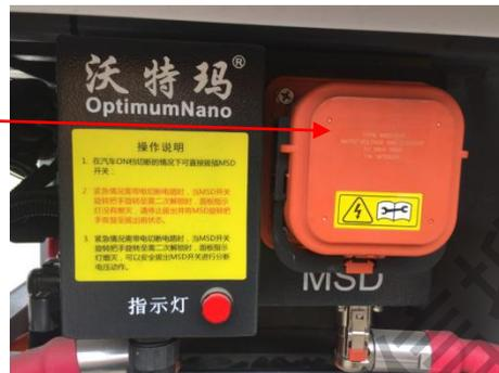
在遇到高压故障时，不要轻易拔插高压维护开关，要及时联系高压专员，非专业人员禁止拔插。
