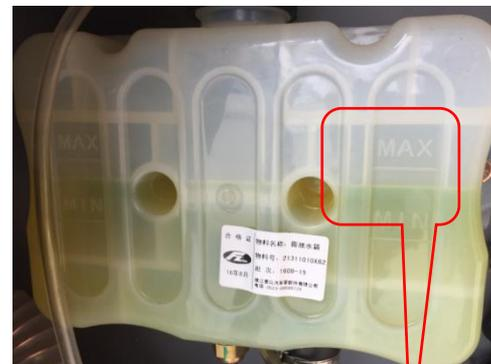
膨胀水箱，根据水箱上的容量加水，水位在MIN和MAX之间最为合适。
