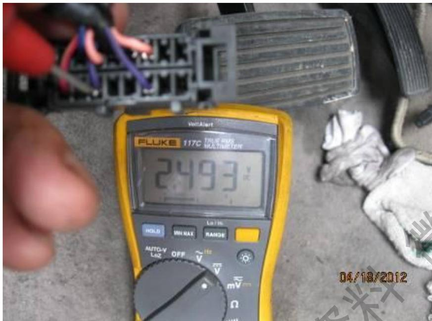
检测高速网总线电压
