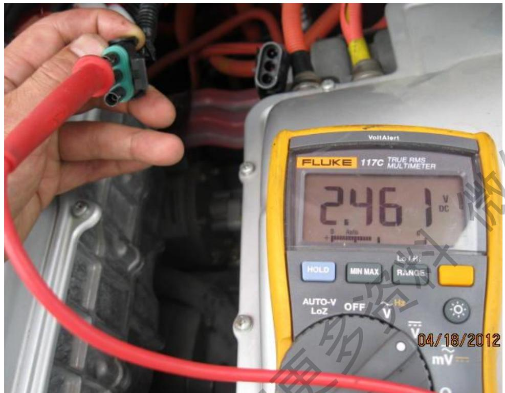
检测DC-DC CAN 进线电压
