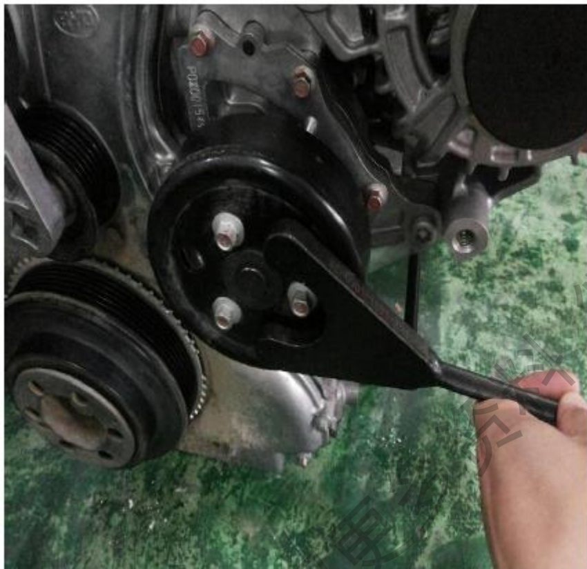
15、使用水泵皮带轮防转工装水泵轮
