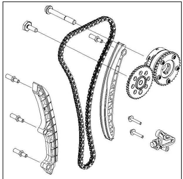
4、将张紧链板挂靠到位，与链条接触部分涂适量机油。装上链条张紧器，并在摩擦面上涂适量机油。拔下箭头所指张紧器锁定销，使链条张紧；
