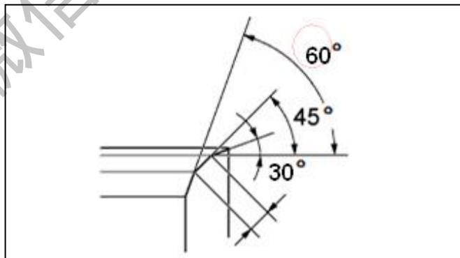
(3) 用 30° 和 60° 的铰刀，修整 45° 密封面，保证气门能完全与座圈密封，并保证密封面的宽度达到要求；
