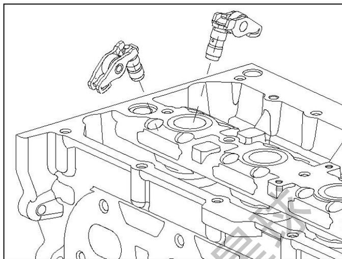
(3) 将火花塞孔密封圈、OCV 滤网安装到气缸盖上。
