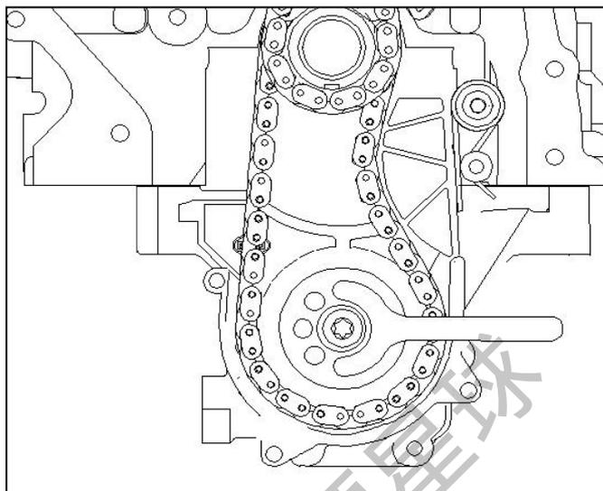
(4) 在张紧板销轴外表面涂抹机油后穿过机油泵链条张紧板，拧紧张紧板销轴；
