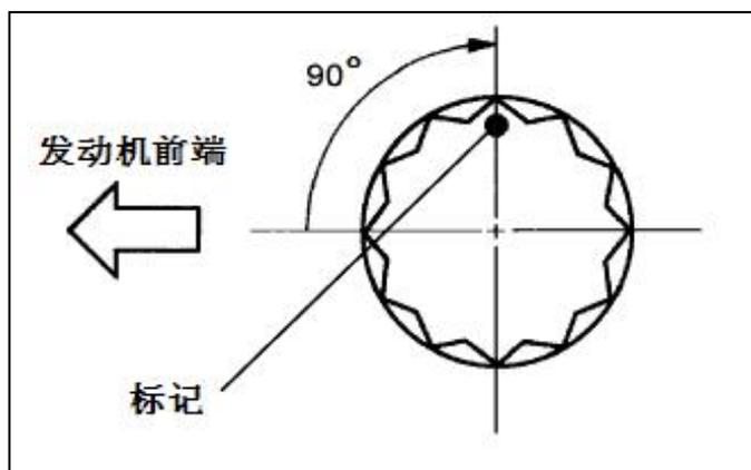
(8) 顺时针旋转连杆螺栓  $90^\circ$ ，重新拧紧连杆螺栓；
