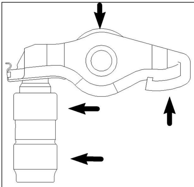
(2) 将滚子摇臂组件缓慢地装入柱塞孔，避免损伤挺柱表面；
