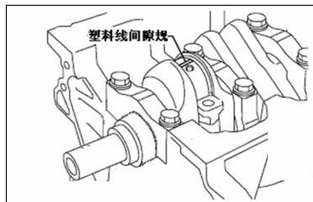
(5) 旋下 2 个连杆螺栓，取下连杆盖和连杆下瓦；
