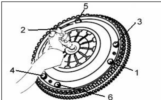
(2) 旋下图示 6 个固定螺栓，取下离合器。
