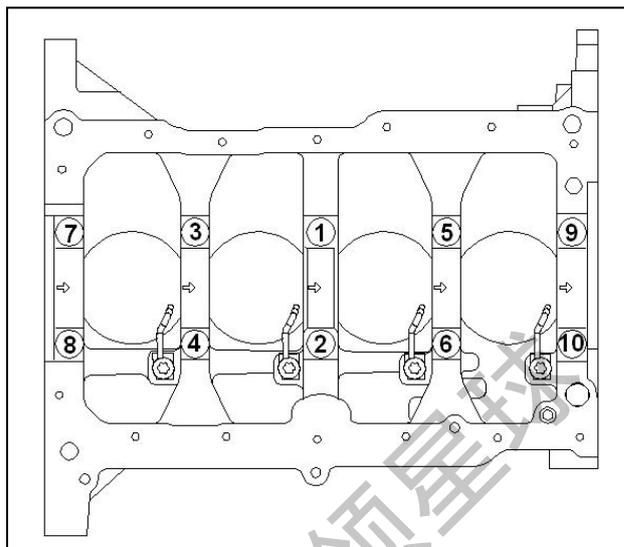
(5) 旋下一档主轴承盖螺栓，取下主轴承盖和主轴瓦；
