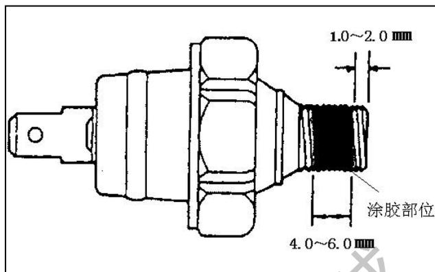
**注意：安装好机油压力开关后 1 小时内不要启动发动机；**
