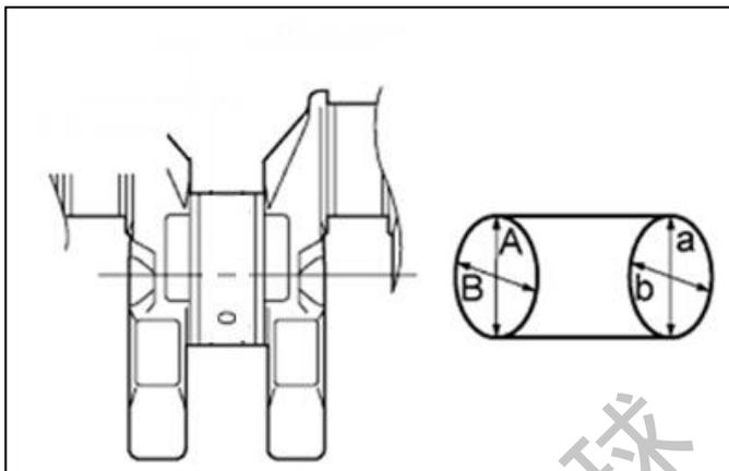
(2) 在下图所示的位置，用千分尺测量每个连杆轴颈的直径；
