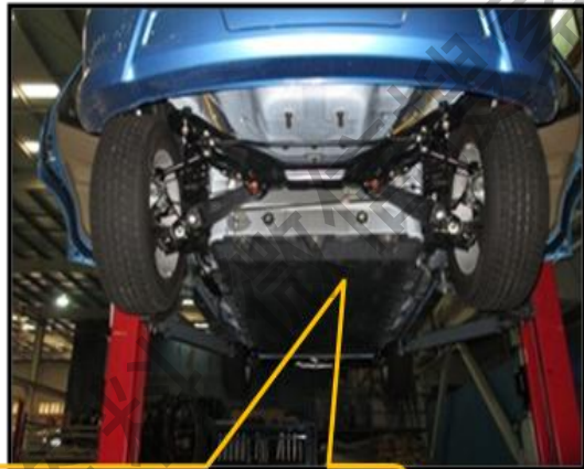
举升轿车，高度1.2m左右，观察动力电池托盘边缘及底部
