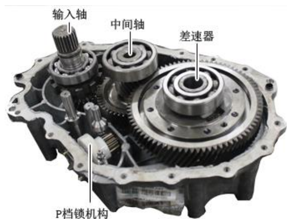
图 4-9 减速器内部结构
