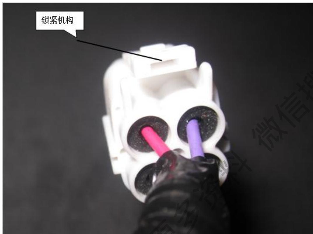
构插入，听到咔的一声才是锁紧接插件。未听到锁紧声音，需查找原因，直到锁紧。拔下接插件时，按下锁紧机构，握住接插件（不能以拉扯线束方式拔出）用力拔出即可，拔出后裸露的端子避免接触到金属。
