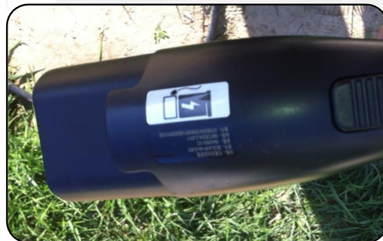
充电桩供电端充电枪
