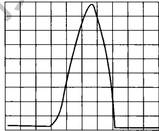
图 6-5 加谐波抑制电感时的电流波形
