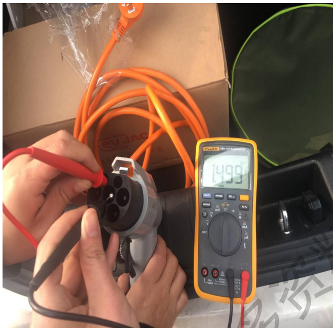
家用充电线缆测量CC信号 与PE阻值为1.5K \Omega
