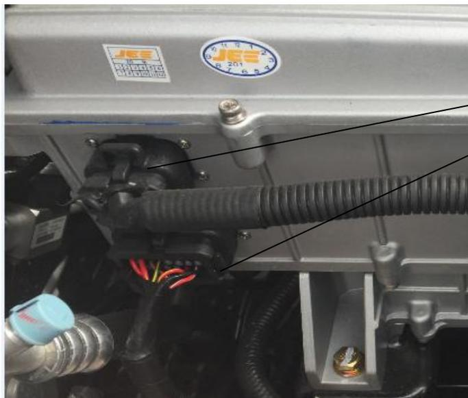
拔下23PIN和14PIN接插件
