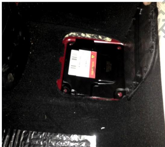
拆下维修开关上盖
