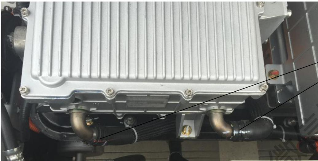
用水管卡钳拆下进出水管
