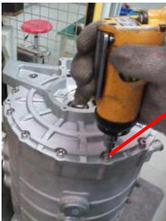
拆掉后端盖紧固螺钉（11只M6X25内六角）（15N.m）1只M6X16专用螺钉
