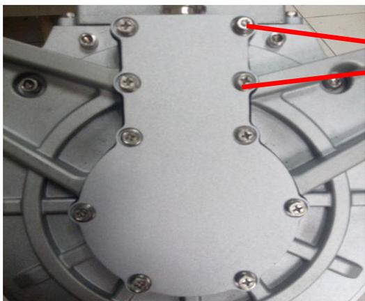
拆下8个M5X16十字槽外六角螺钉（扭力5~7N.m）
