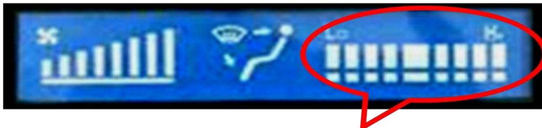
冷区 + A/C=压缩机启动 +PTC 不启动=冷风
