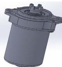
**电机总成:** 安装在转向器上的电机总成由一个蜗杆, 一个蜗轮和一个直流电机组成。当蜗杆与安装在转向器输出轴上的蜗轮啮合时, 它降低电机速度并把电机输出力矩传递到输出轴。
