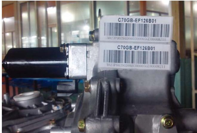
减速器总成条形码编号：供应商代码（A023P00391）+年（字母）+月（两位数字）+日（两位数字）+流水号（五位）+平台代码（D）+减速器总成代码（E00011819）
