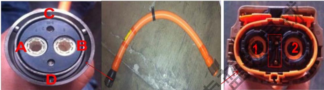
2、电机控制器电缆：连接高压盒到电机控制器之间的线缆
