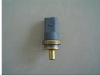
图3-6 冷却液温度传感器简图
