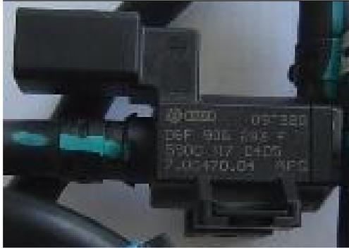
图3-55 增压压力限值电磁阀
