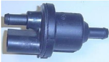
图3-61 碳罐控制阀
