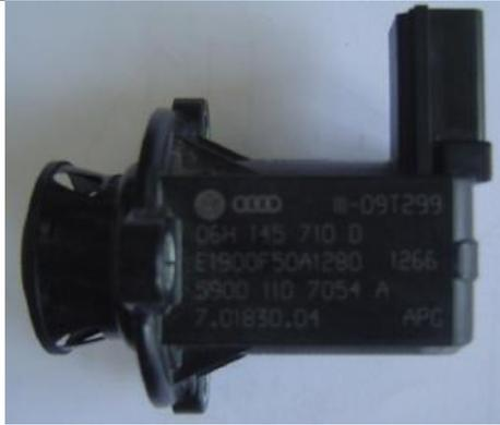
图3-53 涡轮增压器空气循环阀
