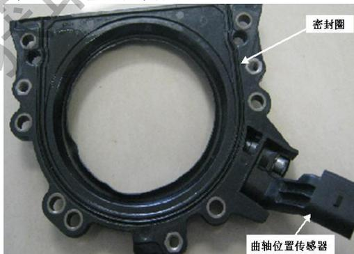
图3-17 曲轴位置传感器及其密封圈简图
