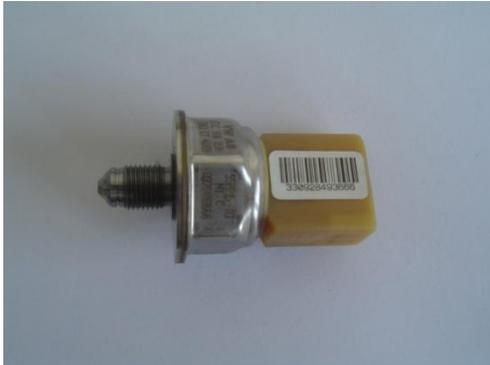
图3-30 高压燃油压力传感器简图
