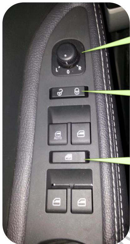
倒车镜调整开关旋钮
