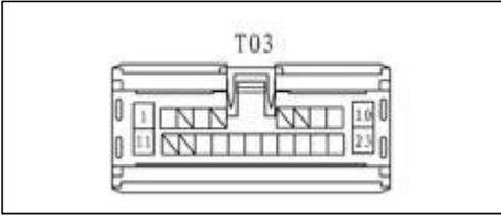
(a) 断开接插件 T03，测线束端电压。
