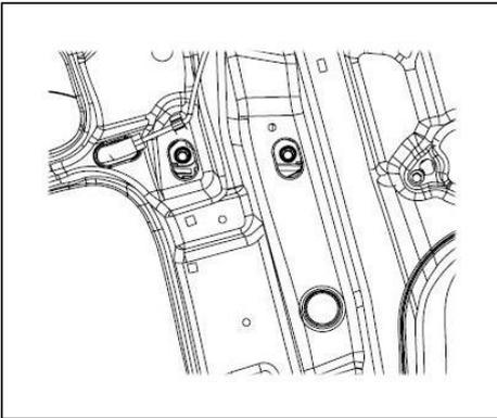
(b) 用 10#套筒拆卸两个固定螺栓。
