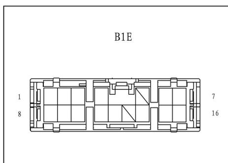
(a) 断开继电器控制模块连接器 B1E。
