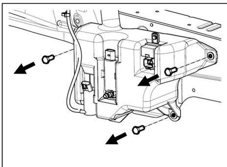
(c) 用 10# 套筒拆卸 3 个螺栓。
