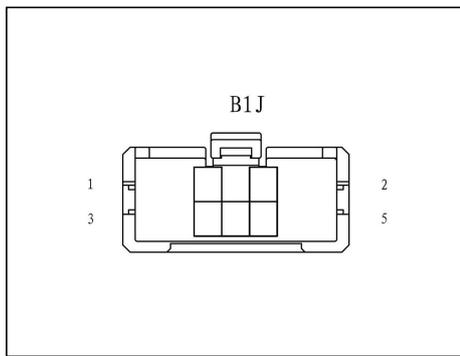
(a) 断开继电器控制模块连接器 B1J。
