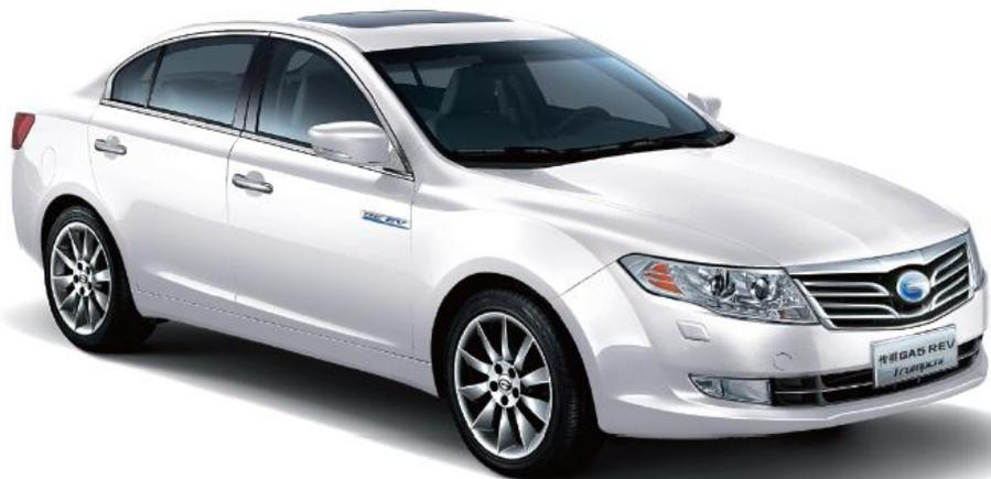
增程电动传祺是以传祺GA5为原型车进行开发，搭载 **13千瓦时** 锂动力电池，纯电动状态下，整车最大可行驶80公里以上，车辆总续驶里程 **大于600公里**，0到50公里加速时间仅为 **4.6秒**，最高车速达 **≥ 150公里**，同时油耗仅为 **2.4L/100KM**，与同级别传统动力车型相比，油耗大幅降低。
