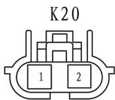
(a) 断开报警器 K20 连接器，给报警器通通蓄电池电，检查报警器是否工作。
