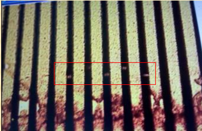
COF金手指断裂处，OM透射光状态下漏光
