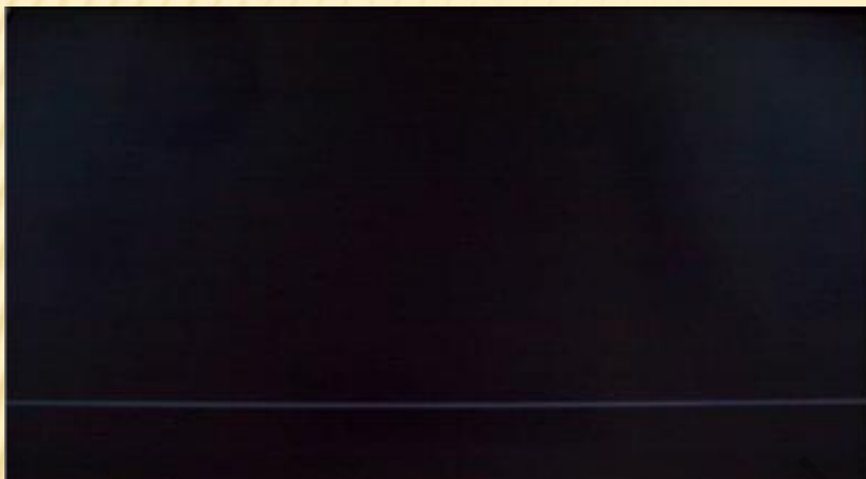
横向：COF不良/bonding不良/CELL不良
