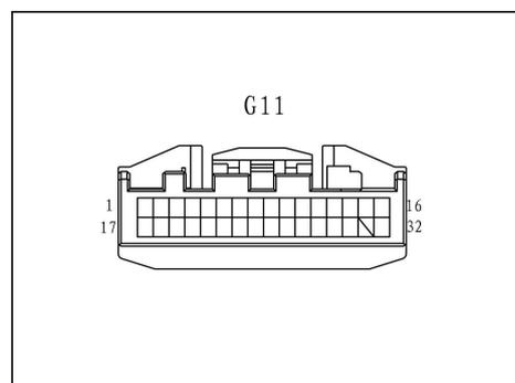
(a) 不断开 G11 连接器，从连接器后部引线，检查对应端子电压。
