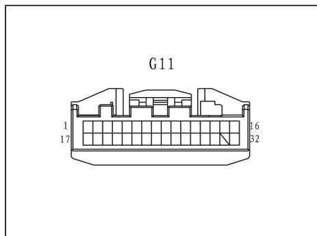
(a) 断开 G11 连接器，断开 C21，T15，U08，K33 连接器。
