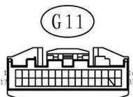
(a) 从全景影像控制器 G11 连接器后侧引线。
