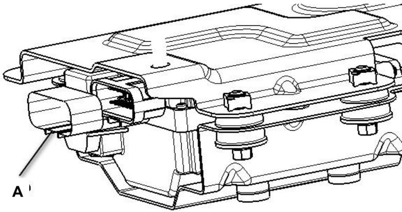
(2) 拆卸 EPB 支架安装螺栓 (A)，取下 EPB 模块与下支架 (B)；
