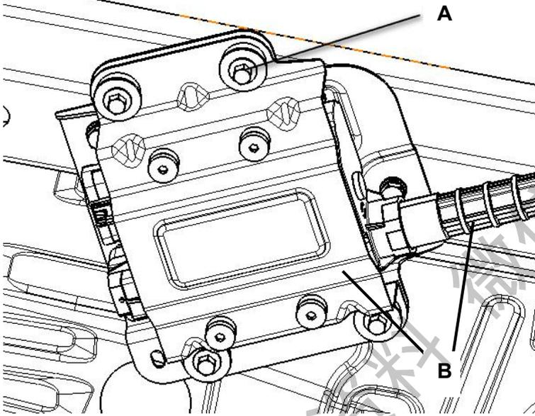
(3) 使用 M5 内六角扳手拆卸 EPB 模块安装螺栓 (A)，取下 EPB 模块 (B)；
