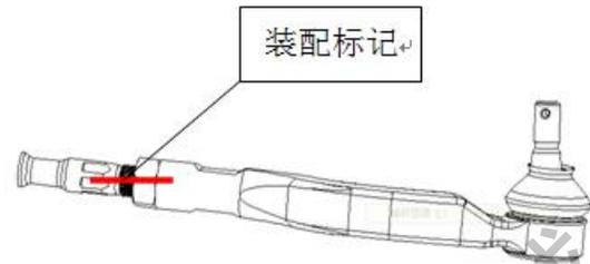
17、拆卸左侧外拉杆总成。
