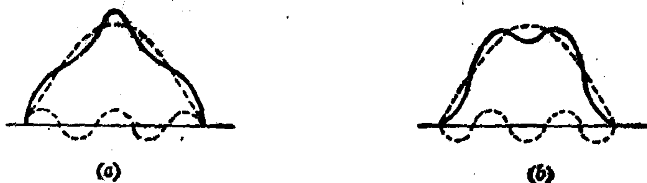
图5-40 五次调谐逆程脉冲波形
