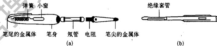
图 1-47 低压验电器
