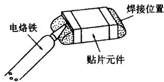
图 1-2 贴片元件的检查方法
