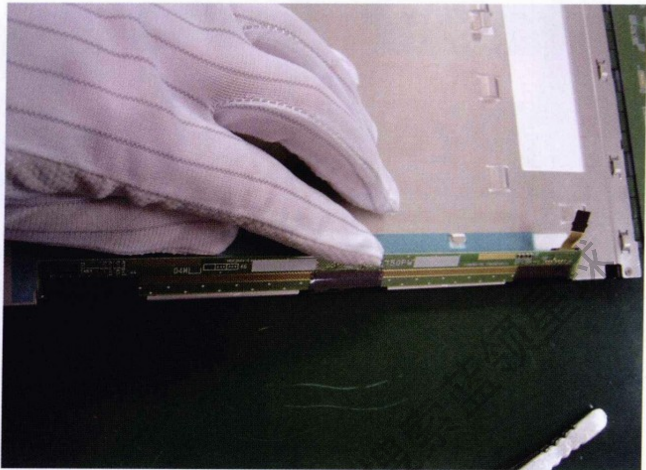
图 7-1-16 卸下逻辑板/PWB 电路板
