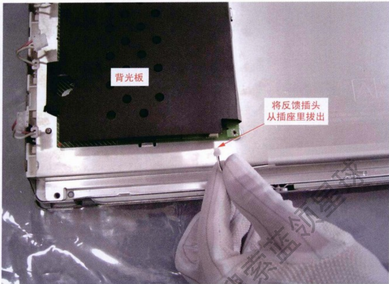
图 7-2-6 拔下背光灯反馈插头
