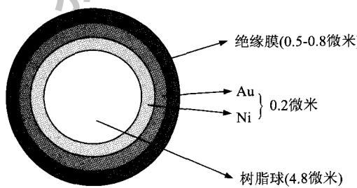
图1 导电粒子结构示意图
