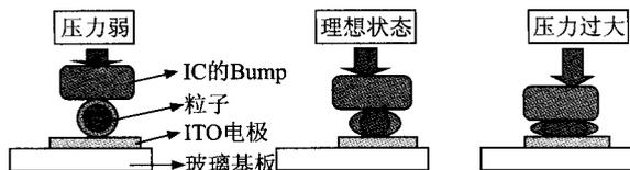
图 3 压力控制图
