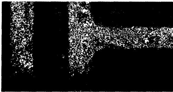
图6 对位不良造成的缺陷
