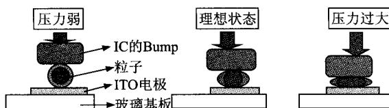
图3 压力控制图
