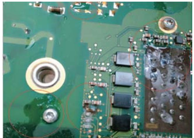
图15 内部线路板腐蚀位置
