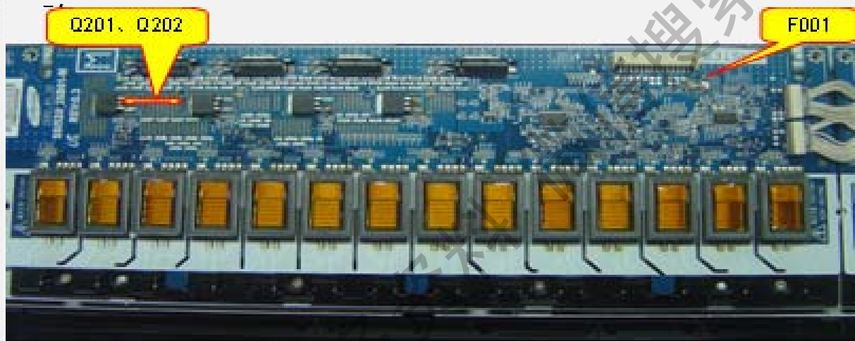
图15: 背光板 F001 、 Q201 、 Q202 ( APM4008 ) 坏; F002 、 Q401 、 Q402 坏
