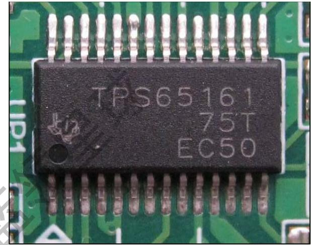
TPS65161:⑨脚STB高电平3.3V有效接CM2679B(53)脚, (20) (21) +12V输入, (27)脚为VAA13.7V供电控制低电平有效。④⑤脚为13.7V。③⑧⑩与外部电容CP16CP17CP18二极管DDP5配合产生20V VGHP电压, (11)脚与外部CP22 DP8产生-5.5V VGL电压。
