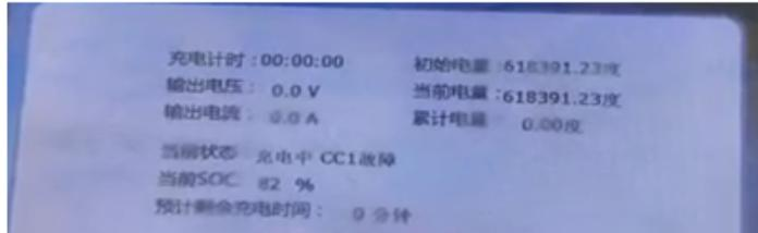
根据上图的信息，这台充电桩的故障现象是：CC1故障，也就是充电枪连接故障。
