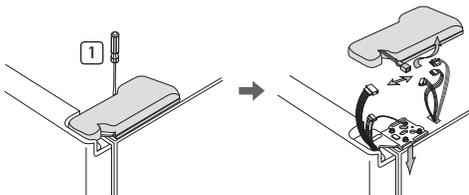
2. 逆时针旋转铰链螺钉 ② 和地线螺钉 ③ 将其拆除并卸下上部的铰链 ④。小心不要让门在拆除过程中滑落。
