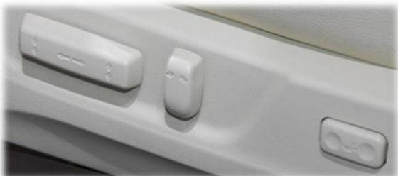
**主驾座椅：**水平调节、高度调节、座盆角度调节、靠背倾斜角度调节、腰靠调节。
