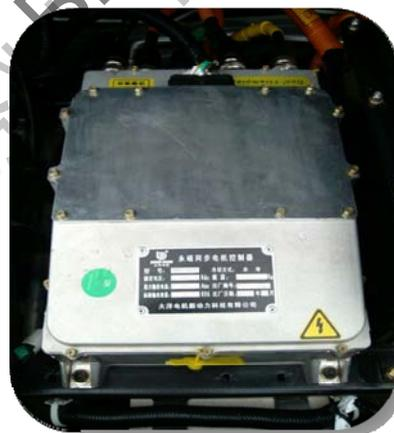
1. 驱动电机控制器其将动力电池提供的直流电，转化为交流电，然后输出给电机；
