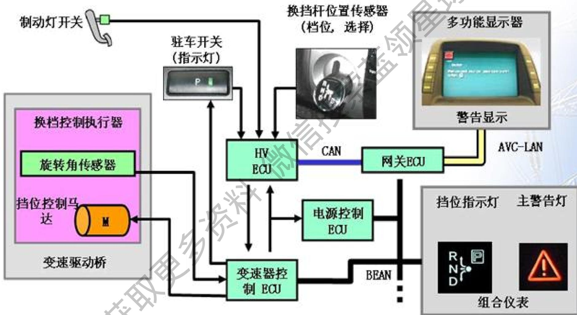
换换挡控制系统原理
