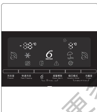
在解锁状态下，同时按住“第六感”或“出冰/水”和“报警解除”键3秒，处于锁定状态，此时锁定图标点亮；再次按住“第六感”或“出冰/水”和“报警解除”键3秒，锁定解除，此时锁定图标不亮。
