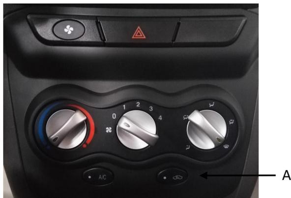
图 70 空气内循环按键开关
