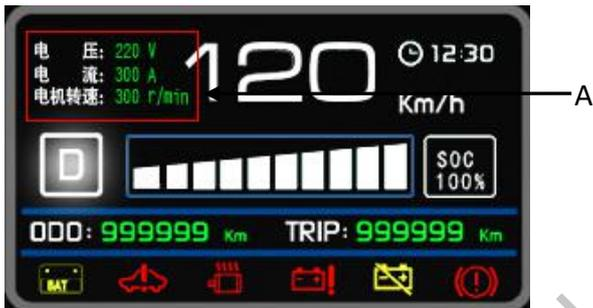
图 23 电压电流显示
