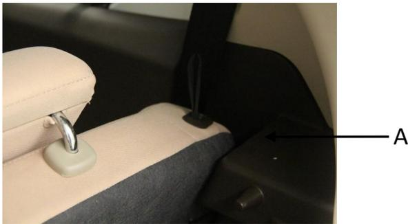
图 6b 右边后座椅锁止机构
