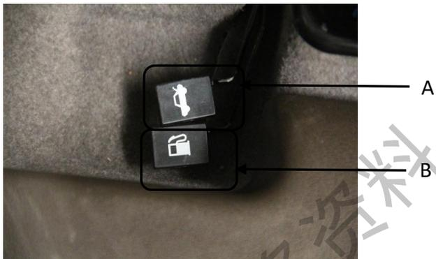
图 101 充电插座口盖开关
