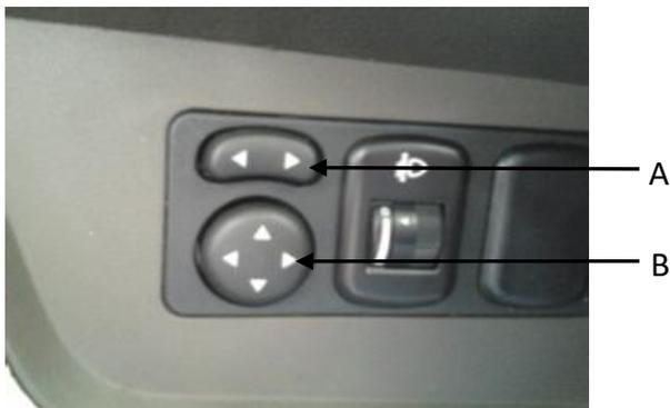
图53 外后视镜角度调节开关
