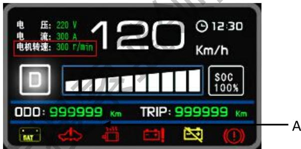
图 24 电机转速显示
