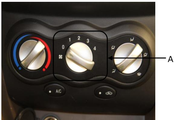
图 67 鼓风机旋钮开关
