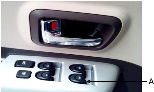
图 40 左前门控制右前门玻璃升降开关
